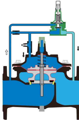
当上游压力高于先导阀设定压力时，先导阀开启，主阀上阀盖室排水，同时主阀开启。
