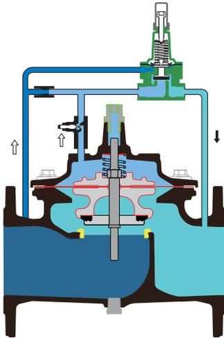
当上游压力低于先导阀设定压力时，先导阀关闭，主阀上阀盖室进水，主阀关闭。
